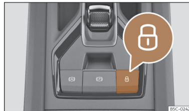
Ábra 79 A középkonzolon: központi zár kapcsológombja
