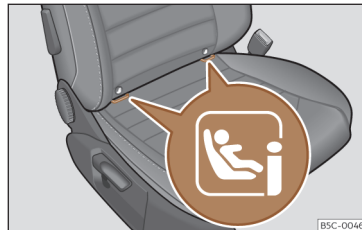
Ábra 41 Utasoldali első ülés: i-Size rögzítőszemek beépítési helye.
