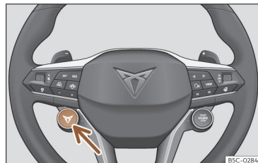
Ábra 128 Multifunkciós kormánykerék: kapcsoló a menetprofil váltásához
