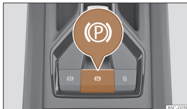
Ábra 155 A középkonzol alsó tartományában: elektronikus parkolófék kapcsológombja.
