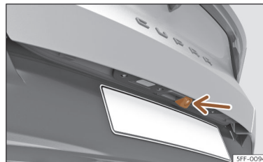
Ábra 136 A csomagterájtó fogantyújában: tolatási asszisztens kamerájának a beépítési helye.
