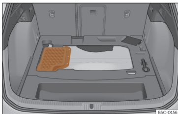
Ábra 232 Plug-in-hibrid járművek (PHEV): Akkumulátor beépítési helye a csomagterben
