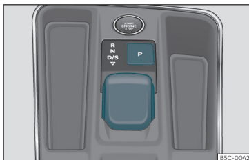
145. ábra A középkonzolban: választókar.
