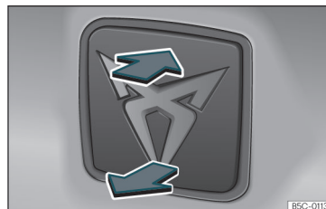
81. ábra Csomagtérajtó: nyitás kívülről.
