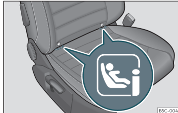
28. ábra Utasoldali első ülés: ISOFIX/i-Size rögzítőszemek.
