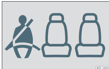
5. ábra Műszerfalbetét: jelzi, hogy a bal oldali hátsó ülés foglalt és az utas a biztonsági övét becsatolta.
