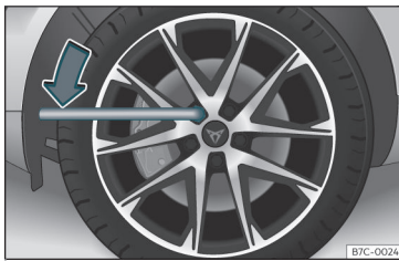
37. ábra Kerékcserre: kerékcsavarak meg lazítása.
