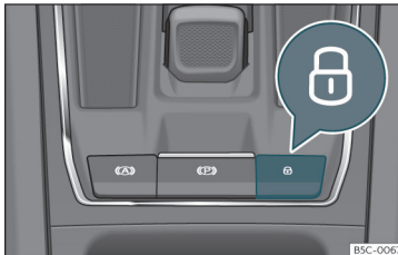
75. ábra A közép konzolban: központi zár kapcsoló
