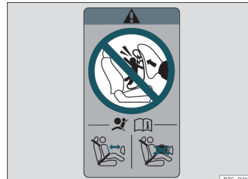
26. ábra Légzsák matrica: jobb oldali első ajtókeret hátsó élen
