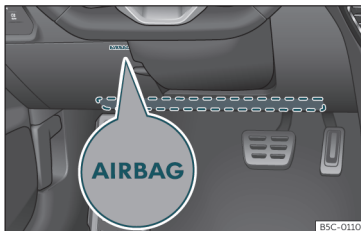
17. ábra A vezető oldalán: a térdlégzsák beépítési helye.
