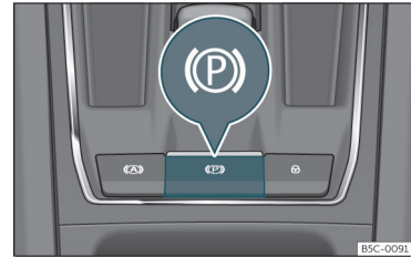
175. ábra A középkonzol alsó tartományában: elektronikus parkolófék kapcsolója.
