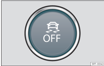
177. ábra A középkonzol alsó tartományában: gomb az ESC be-/kikapcsolásához
