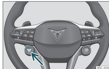
147. ábra Multifunkciós kormánykerék*: Kapcsoló a menetprofil váltáshoz
