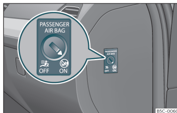
15. ábra Kulcsos kapcsoló a vezető melletti ülés légzsákjának be- és kikapcsolásához.
