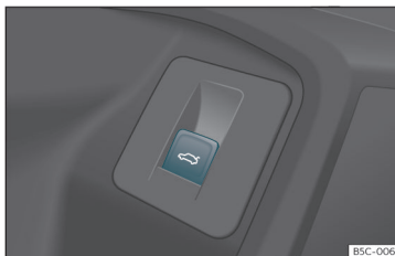
83. ábra A vezető ajtaján: gomb a csomagterájtó nyitáshoz és záráshoz.
