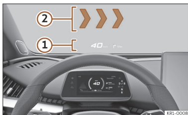
Ábra 5 Az vezető látóterében: Kivetített kijelző (HUD) ① kivetített kijelző (HUD), AR (kiterjesztett valóság információkkal) ②.
