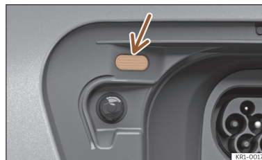
Ábra 59 Az akkumulátortöltő fedele mögött: Töltési folyamatkijelző.
