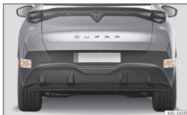
Ábra 112 A jármű hátsó nézete: a radarérzékelők tartományai.
