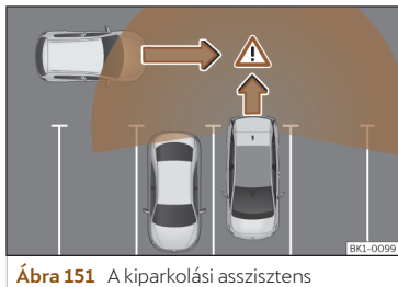
Ábra 151 A kiparkolási asszisztens vázlatos ábrázolása: a kiparkoló jármű által megfigyelt tartomány.
