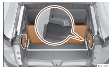
Ábra 169 A csomagtérben: második csomagtérpadló rögzítése több állásban.
