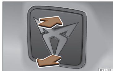
Ábra 78 Csomagtérajtó: nyitás kívülről
