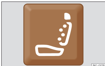
Ábra 92 A vezető- és az első utas ülésének alsó részén: masszázsfunkció kapcsológombja.
