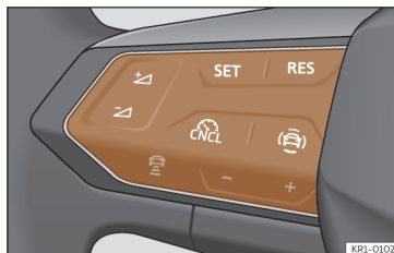
Ábra 118 A multifunkciós kormánykeréken: gombok az ACC kezeléséhez.
