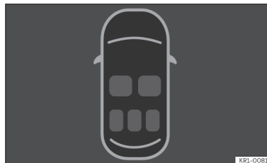
Ábra 17 Műszerfalbetét: A biztonsági övek állapotkijelzései.
