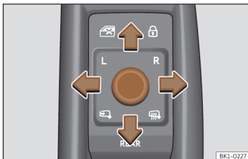
Ábra 99 A vezető ajtajának részlete: külső tükör kezelése.
