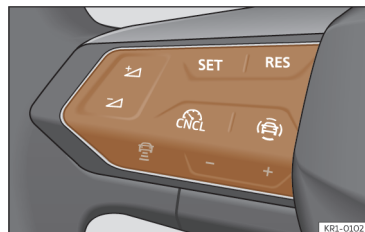
Ábra 127 A multifunkciós kormánykerék bal oldali részlete.
