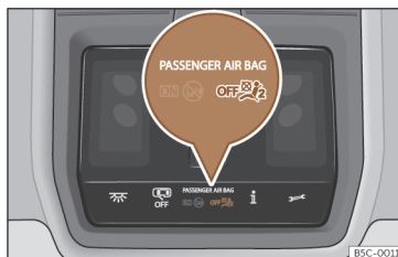
Ábra 27 A tetőkonzolban: utasoldali első légzsák ellenőrző lámpája nem világít.
