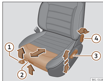
Ábra 84 Első ülések: manuális ülésbeállítás.
