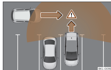
Ábra 147 A kiparkolási asszisztens vázlatos ábrázolása: a kiparkoló jármű által megfigyelt tartomány.
