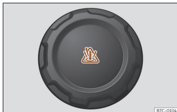
Ábra 186 Jármű első tartománya: hűtőfolyadék kiegyenlítő tartályának zárókupakja.
