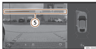
Ábra 139 Az Infotainment-rendszer képernyőjén: Távolságjelző szegmens az előrehaladáshoz
