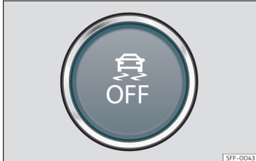
188. ábra A középkonzol alsó tartományában: gomb az ESC be-/kikapcsolásához
