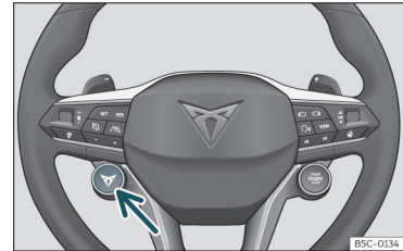
158. ábra Multifunkciós kormánykerék*: Kapcsoló a menetprofil váltásához
