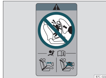
30. ábra Légzsák matrica: jobb oldali első ajtókelet hátsó élén
