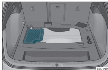
222. ábra Akkumulátor beépítési helye a csomag-térben
