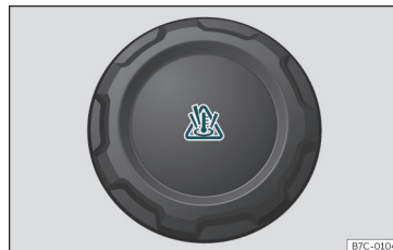
218. ábra Motortér: motor hűtőfolyadék kiegyenlítő tartályának fedele.
