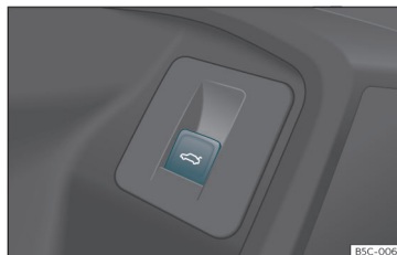
87. ábra A vezető ajtaján: gomb a csomagtérajtó nyitásához és zárásához.
