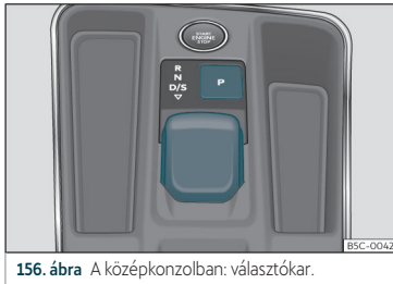
156. ábra A középkonzolban: választókar.
