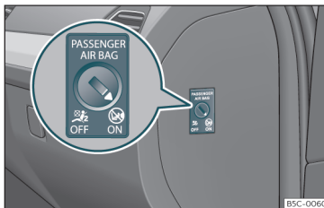
19. ábra Kulcsos kapcsoló a vezető melletti ülés légzsákjának be- és kikapcsolásához.
