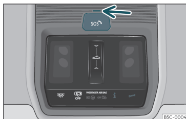
36. ábra A tetőkonzolban: kapcsoló a beszédalapú szolgáltatásokhoz
