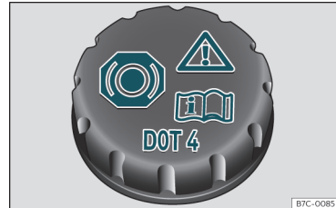
219. ábra Motortér: fékfolyadék tartályának fedele.
