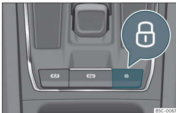
79. ábra A közép konzolban: központi zár kapcsoló
