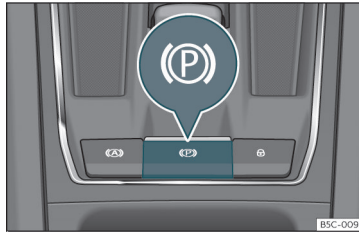
186. ábra A középkonzol alsó tartományában: elektronikus parkolófék kapcsolója.
