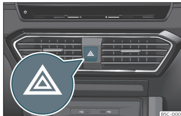
96. ábra Műszerfal: vészvillogó kapcsolója.
