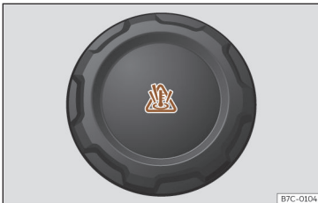
Ábra 202 Jármű első tartománya: hűtőfolyadék kiegyenlítő tartályának zárókupakja.
