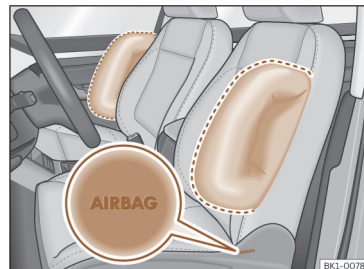
Ábra 32 Oldallégszák a vezető- és az utasoldali első ülésben.
