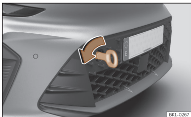
Ábra 194 Az első lökhárító jobb oldali részlete: becsavart vonószem
