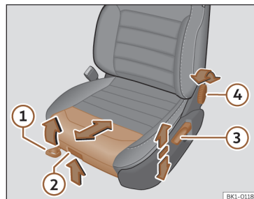
Ábra 86 Első ülések: manuális ülésbeállítás.
