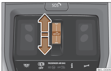
Ábra 103 A tetőkárpitban: A napfényroló kezelőfelülete.
