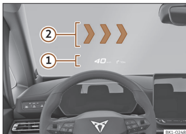
Ábra 4 A vezető látóterében: Kivetített kijelző (HUD) ① kivetített kijelző (HUD), AR (kiterjesztett valóság információkkal) ②.
