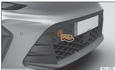
Ábra 193 Az első lökhárító jobb oldalán: távolítsa el a takaróelemet.
