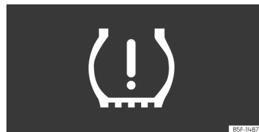
Ábra 244 Műszerfalbetét: figyelmeztetés a gumibroncsnyomás csökkenésére.
