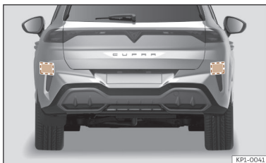
Ábra 126 A jármű hátsó nézete: a radarérezékelők tartományai.
