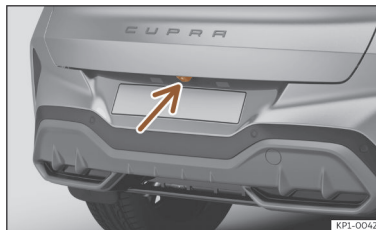
Ábra 128 A csomagterajtő fogantyújában: tolatási asszisztens kamerájának a beépítési helye.
