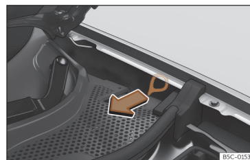
Ábra 65 A bal oldali sárvédő és a motorháztető zsanérja között: húzófogantyú a töltőkábel csatlakozódugójának manuális kireteszeléséhez.
