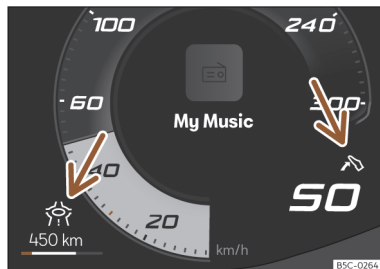
Ábra 138 Eco-asszisztens kijelzései (elvi ábrázolás)
