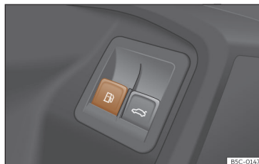
Ábra 210 A vezető ajtaja: tanksapkafedél kireteszelő gombja.
