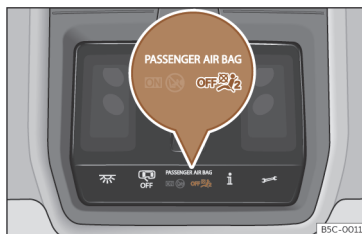
Ábra 29 A tetőkonzolban: utasoldali első légzsák ellenőrző lámpája nem világít.
