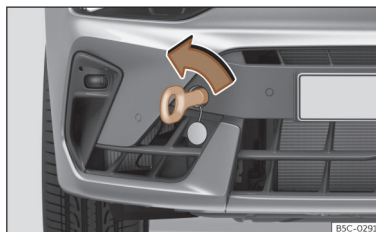
Ábra 220 Az első lökhárító jobb oldali részlete: becsavart vonószem
