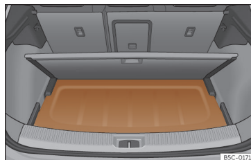
Ábra 184 A csomagtérben: a csomagtérfedél elhelyezése.
