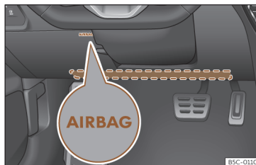
Ábra 35 A vezető oldalán: a térdlégzsák beépítési helye.
