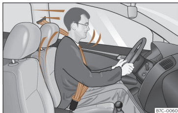
Ábra 18 A biztonsági övet helyesen használó vezető egy hirtelen fékezés során nem csapódik előre.
