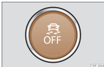
Ábra 128 A középkonzol alsó tartományában: gomb az ESC be-/kikapcsolásához (változattól függ).
