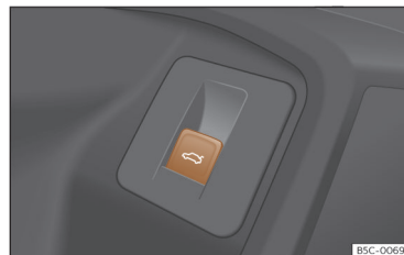
Ábra 84 A vezető ajtaján: gomb a csomagtérajtó nyitásához és zárásához.
