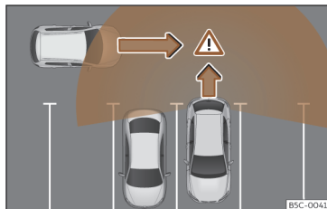
Ábra 165 A kiparkolási asszisztens vázlatos ábrázolása: a kiparkoló jármű által megfigyelt tartomány.
