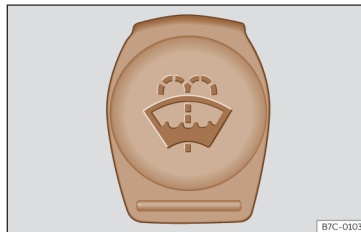
Ábra 232 Jármű első tartományában: Ablakmosó-folyadék tartályának kék fedele.
