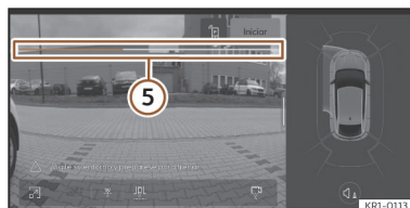
Ábra 161 Az Infotainment-rendszer képernyőjén: Távolságjelző szegmens az előrehaladáshoz
