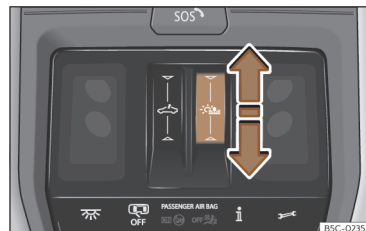
Ábra 91 A tetőkárpitban: Napvédő roló kezelése.
