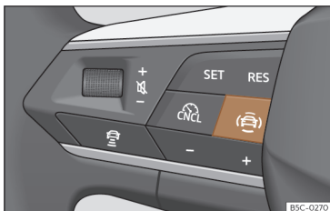
Ábra 129 A multifunkciós kormánykerék bal oldali részlete: kapcsológomb a vezetésségítő rendszerek kezeléséhez (modellfüggő).
