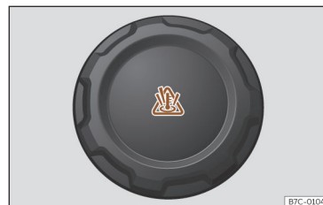
Ábra 230 Jármű első tartományában: hűtőfolyadék kiegyenlítő tartályának zárókupakja.
