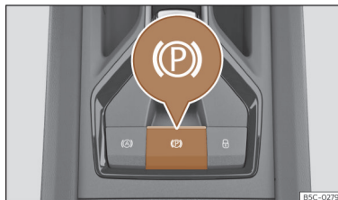
Ábra 154 A középkonzol alsó tartományában: elektronikus parkolófék kapcsológombja.
