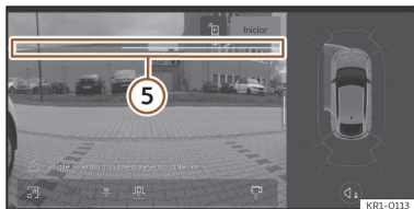
Ábra 163 Az Infotainment-rendszer képernyőjén: Távolságjelző szegmens az előrehaladáshoz
