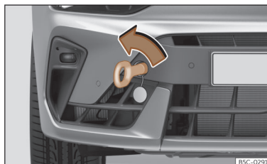
Ábra 224 Az első lökhárító jobb oldali részlete: becsavart vonószem
