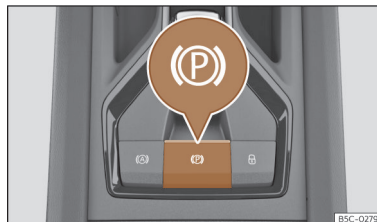
Ábra 156 A középkonzol alsó tartományában: elektronikus parkolófék kapcsológombja.
