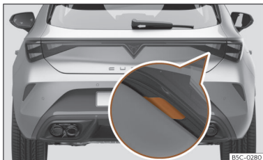
Ábra 82 Csomagtérajtó: nyitás kívülről
