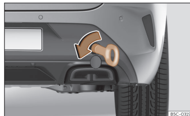
Ábra 227 Leon Sportstourer. A hátsó lökhárító jobb oldalán: becsavart vonószerem.
