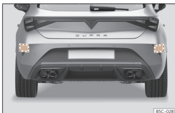
Ábra 134 A jármű hátsó nézete: a radarérzékelők tartományai.
