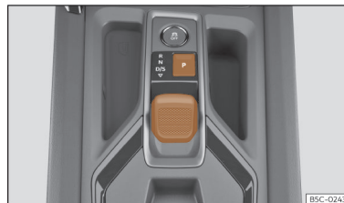
Ábra 126 A középkonzolban: Választókar
