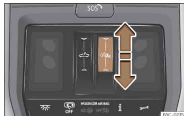
Ábra 91 A tetőkárpitban: Napvédő roló kezelése.
