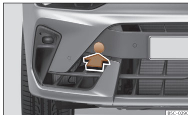
Ábra 223 Az első lökhárító jobb oldalán: távolítsa el a takaróelemet.
