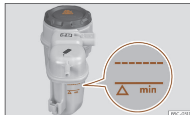
Ábra 236 Jármű első tartományában: Hűtőfolyadék kiegyenlítő tartálya.
