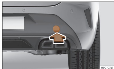
Ábra 225 Leon Sportstourer. A hátsó lökhárító jobb oldalán: távolítsa el a takaróelemet.
