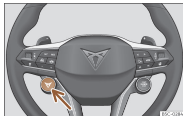
Ábra 128 Multifunkciós kormánykerék: kapcsoló a menetprofil váltásához
