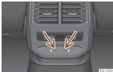
Ábra 176 Középkonzol hátul: USB-csatlakozók töltőaljzat funkcióval.
