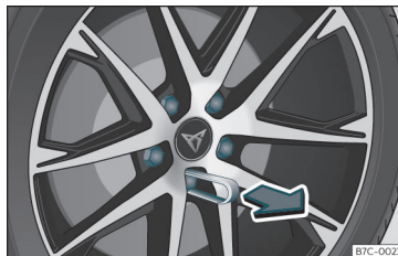
35. ábra Kerék: kerécsavarok védőkupakkal.
