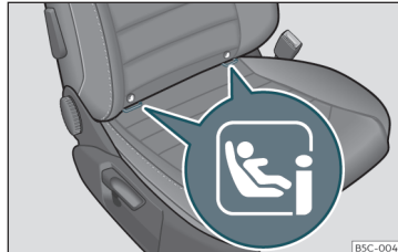
28. ábra Utasoldali első ülés: ISOFIX/i-Size rögzítőszerkezet.
