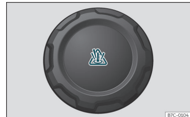
189. ábra Motortér: motor hűtőfolyadék kiegyenlítő tartályának fedele.
