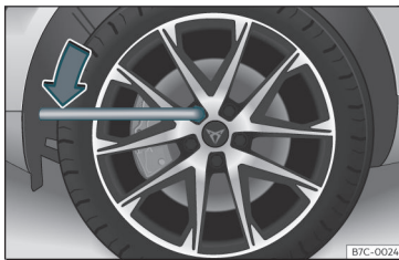
37. ábra Kerékcsere: kerékcsavarak meg lazítása.
