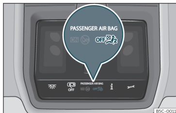
16. ábra A tetőkonzolon: Az első utasoldali légzsák kikapcsolását jelző ellenőrző lámpa.
