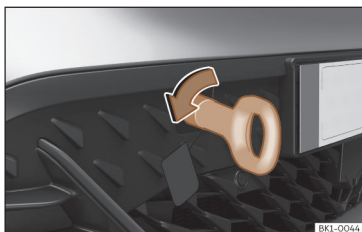
Ábra 51 Lökharító jobb első részén: vonószem becsavarása.
