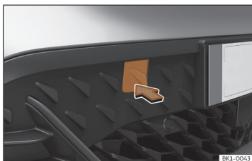
Ábra 50 Lökharító jobb első részén: távolítsa el a takaróelemet.
