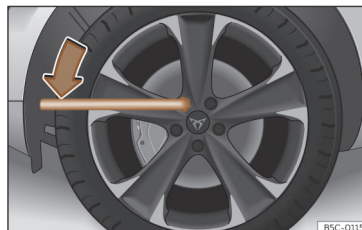
Ábra 200 Keréksere: Kerékcavarok meglaizítása
