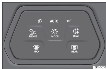
Ábra 103 Műszerfal: világítás kezelőelemei.
