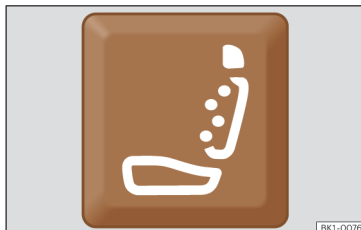
Ábra 102 A vezető- és az első utas ülésének alsó részén: masszázsfunkció kapcsológombja.
