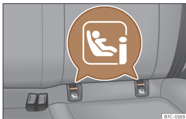
Ábra 52 Hátsó ülés: ISOFIX/i-Size rögzítőszemek beépítési helye.
