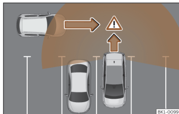
Ábra 154 A kiparkolási asszisztens vázlatos ábrázolása: a kiparkoló jármű által megfigyelt tartomány.
