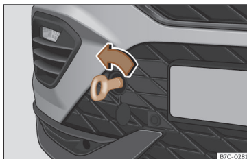
42. ábra Az első lökhárító jobb oldalán: becsavart vonószem.
