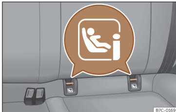
25. ábra Hátsó ülés: ISOFIX/i-Size rögzítőszemek.
