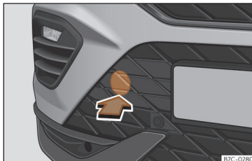
41. ábra Az első lökhárító jobb oldalán: távolítsa el a takaróelemet.
