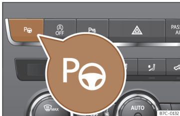
170. ábra A középkonzol felső részében: kapcsológomb a parkolási kormányzási asszisztens bekapcsolásához.
