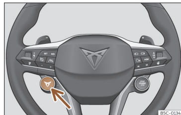
142. ábra Multifunkciós kormánykerék: kapcsoló a menetprofil váltásához
