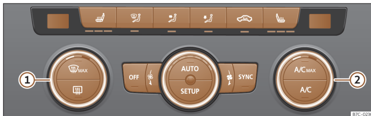
124. ábra A középkonzolban: a Climatronic kezelőelemei.
