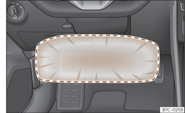
18. ábra A vezető oldalán: a térdlégzsák hatáskörzete.
