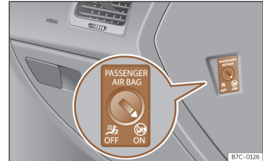
15. ábra Kulcsos kapcsoló a vezető melletti ülés légzsákjának be- és kikapcsolásához.
