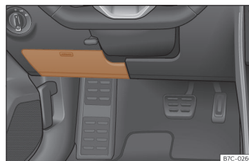
45. ábra Balkormányos: Biztosítékház felele a műszerfal alatt a vezető oldalán.
