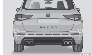
146. ábra Jármű hátsó nézete: a radarérzékelők tartományai.
