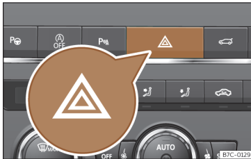
90. ábra Műszerfal: vészvillogó kapcsolója.
