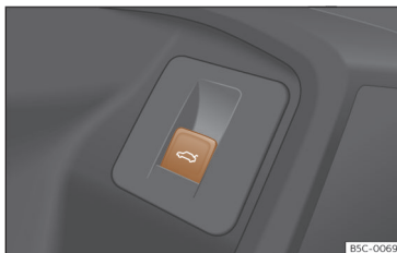
Ábra 84 A vezető ajtaján: gomb a csomagterajtó nyitásához és zárásához.
