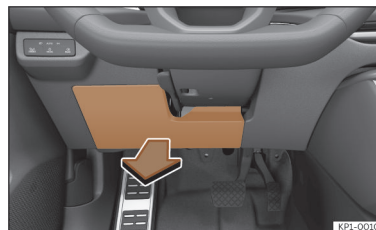
Ábra 217 A vezető oldalán a műszerfalban: biztosítékház fedele.
