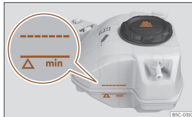
Ábra 224 Jármű első tartományában: Hűtőfolyadék kiegyenlítő tartálya.
