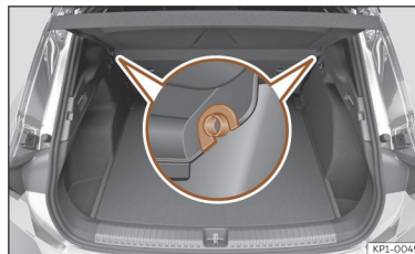
Ábra 183 A csomagtérben: csomagtérfedél ki- és beszerelése.
