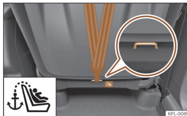
Ábra 44 Jobb oldali első ülés hátoldala: rögzítőelemek a Top Tether rögzítópántokhoz (nem minden exportpiacon/modellre elérhető).
