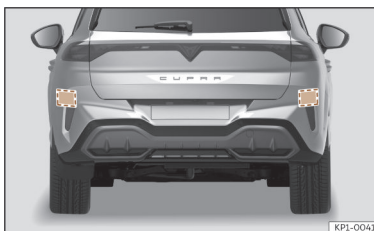
Ábra 127 A jármű hátsó nézete: a radarérzékelők tartományai.
