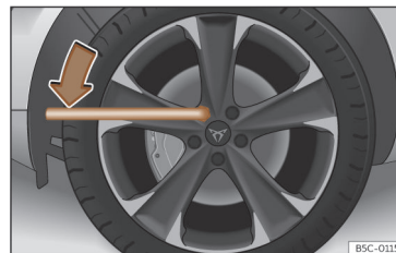
Ábra 243 Kerécsere: Kerécsavarok meglazítása
