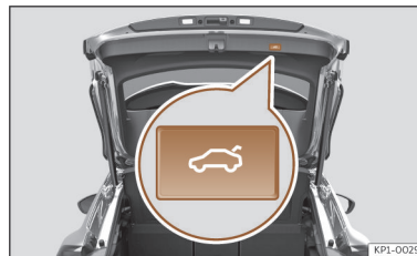
Ábra 83 Csomagtérajtó: gomb a csomagtérajtó zárásához.
