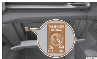
Ábra 30 Kulcsos kapcsoló a vezető melletti ülés légzsákjának be- és kikapcsolásához.
