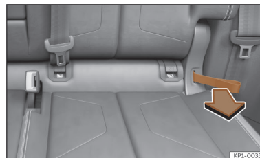
Ábra 96 Hátsó ülés: hátsó ülés előrehajtása.
