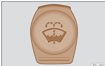
Ábra 227 Jármű első tartományaiban: Ablakmosó-folyadék tartályának kék fedele.
