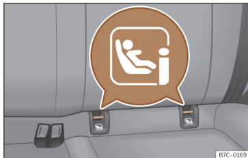
Ábra 36 Hátsó ülés: ISOFIX/i-Size rögzítésszemek beépítési helye.
