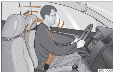
Ábra 16 A biztonsági övet helyesen használó vezető egy hirtelen fékezés során nem csapódik előre.
