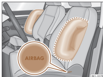
Ábra 32 Oldallégzsák a vezető- és az utasoldali első ülésben.
