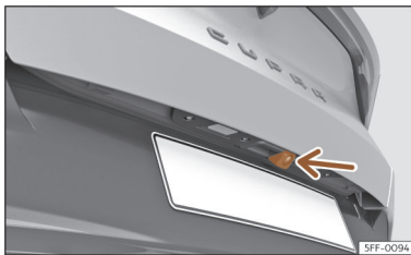
Ábra 136 A csomagtérajtó fogantyújában: tolatási asszisztens kamerájának a beépítési helye.
