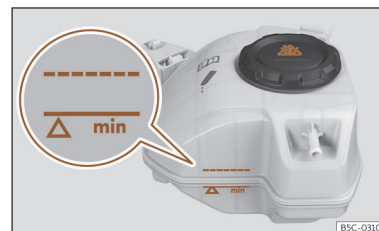
Ábra 225 Jármű első tartományában: Hűtőfolyadék kiegyenlítő tartálya.
