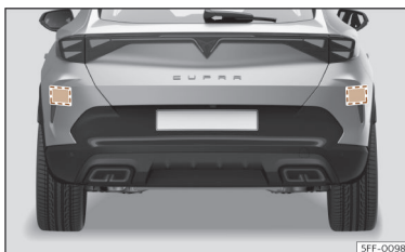
Ábra 134 A jármű hátsó nézete: a radarérzékelők tartományai.
