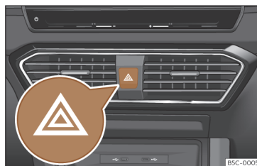
Ábra 50 Műszerfal: vészvillogó kapcsolója
