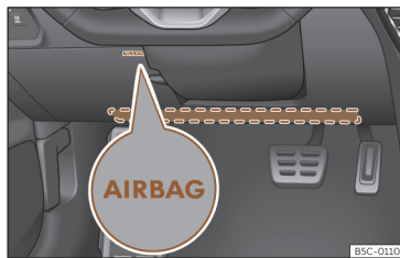
Ábra 35 A vezető oldalán: a térdlégzsák beépítési helye.
