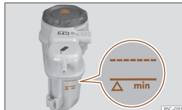
Ábra 226 Jármű első tartományában: Hűtőfolyadék kiegyenlítő tartálya.
