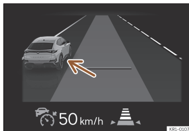
Ábra 120 A műszerfalbetét képernyőjén: ACC aktív, jármű felismerése a bal oldalon.
