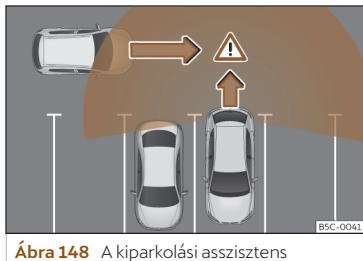
Ábra 148 A kiparkolási asszisztens vázlatos ábrázolása: a kiparkoló jármű által megfigyelt tartomány.
