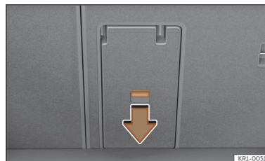
Ábra 170 A csomagtérben: átrakodó nyílás kinyitása.
