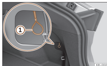
Ábra 62 A burkolat mögött: Töltőkábel csatlakozódugójának kireteszelése szükséghelyzetben.
