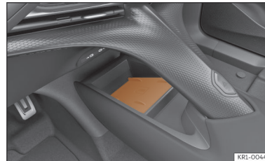
Ábra 161 A középkonzolban: tartó a mobiltelefon párosításához.
