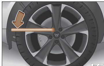
Ábra 202 Kerékcsere: Kerékcsavarok meglaizítása
