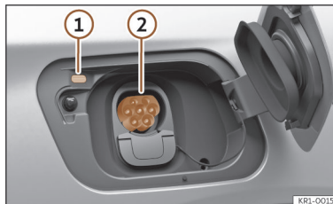
Ábra 56 Az akkumulátortöltő fedele alatt, hátul jobbra: Töltő csatlakozóaljzat.
