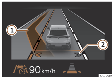
Ábra 129 A műszerfalbetét kijelzőjén: A támogatott sávváltás kijelzései (elvi ábrázolás).
