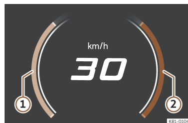
Ábra 3 A digitális műszerfalbetét: Teljesítménykijelző (vázlatos ábrázolás).
