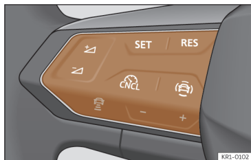
Ábra 119 A multifunkciós kormánykeréken: gombok az ACC kezeléséhez
