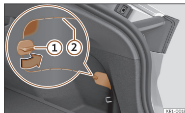
Ábra 61 A csomagterékárpit jobb alsó részében: leválasztható fedél.
