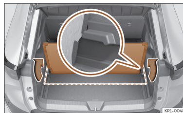
Ábra 166 A csomagterben: második csomagterpadló rögzítése több állásban.
