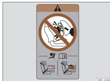
Ábra 36 Matrica a légszák: jobb oldali első ajtókeret hátsó peremén.
