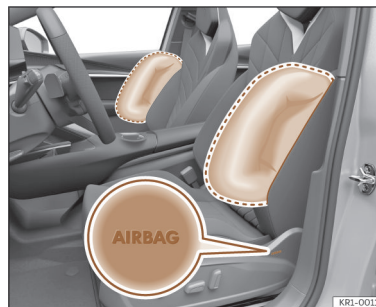
Ábra 31 Oldallégzsák a vezető- és az utasoldali első ülésben.
