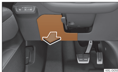
Ábra 187 A vezető oldalán a műszerfalban: biztosítékház fedele.
