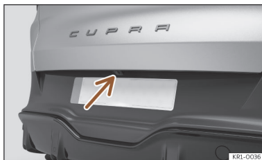
Ábra 114 A hátsó lökhárítóban: tolatókamera beépítési helye.
