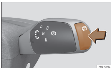
Ábra 134 A menetfokozat-kapcsolón: elektronikus parkolófék kapcsológombja.
