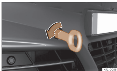
Ábra 184 Az első lökhárító jobb oldali részlete: becsavart vonószem
