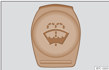
Ábra 196 Jármű első tartományában: Ablakmosó folyadék tartályának kék fedele.
