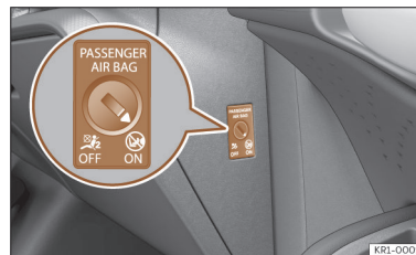
Ábra 27 Kulcsos kapcsoló a vezető melletti ülés légzsákjának be- és kikapcsolásához.
