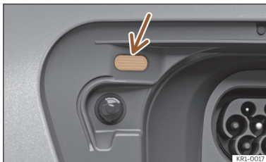
Ábra 59 Az akkumulátortöltő fedele mögött: Töltési folyamatkijelző.
