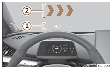
Ábra 4. Az vezető látóterében: Kivetített kijelző (HUD) ① kivetített kijelző (HUD), AR (kiterjesztett valóság információkkal) ②.
