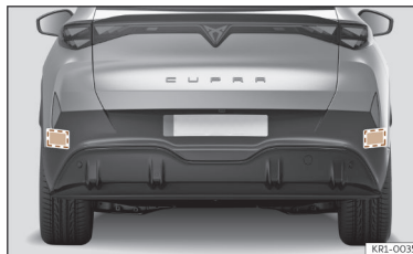
Ábra 112 A jármű hátsó nézete: a radarérezkelők tartományai.
